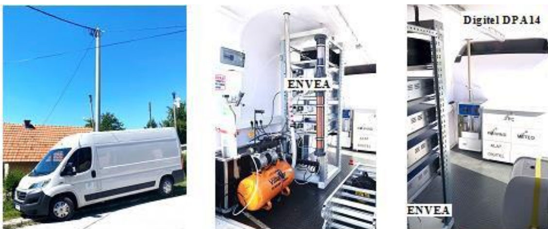
Prikaz 4.7.1: Mobilna stanica za monitoring kvaliteta zraka
