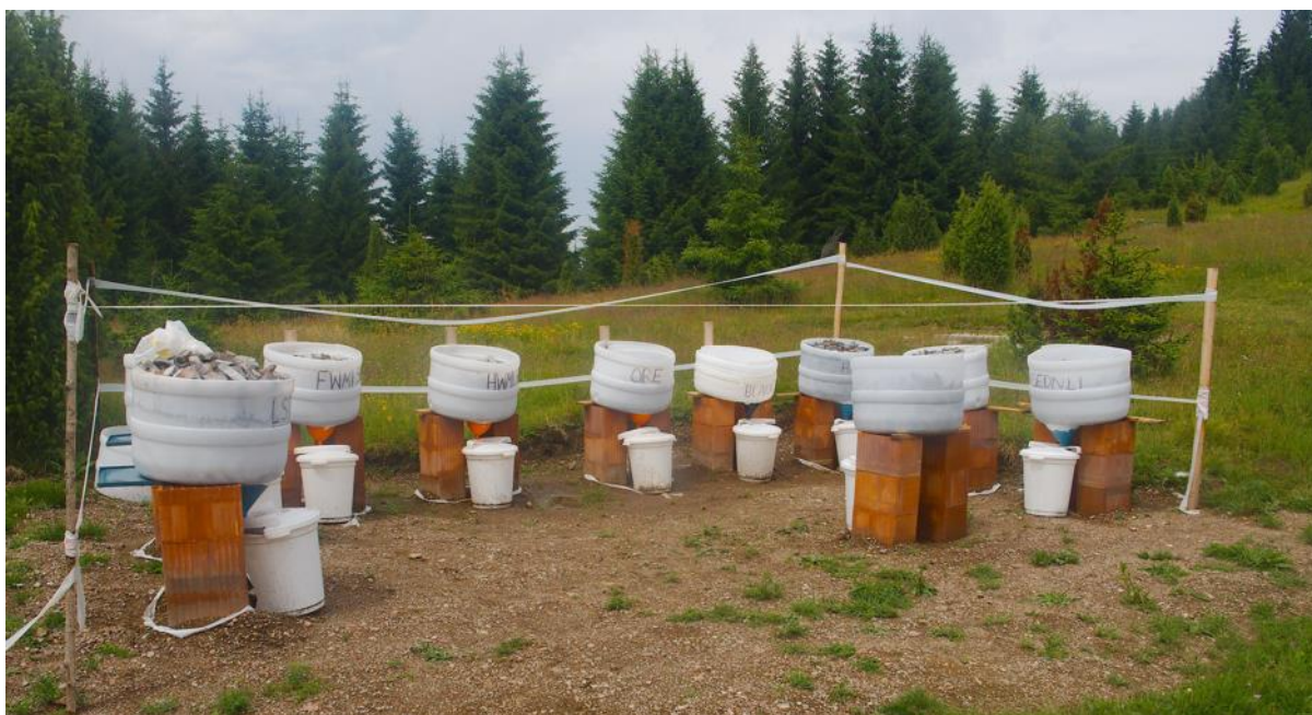
Fotografija 4.10.1 Testovi ispiranja na terenu postavljeni na Rupicama
